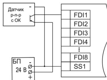
Рисунок 5 – Подключение транзисторов типа p-n-p
