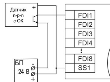
Рисунок 6 – Подключение транзисторов типа n-p-n
